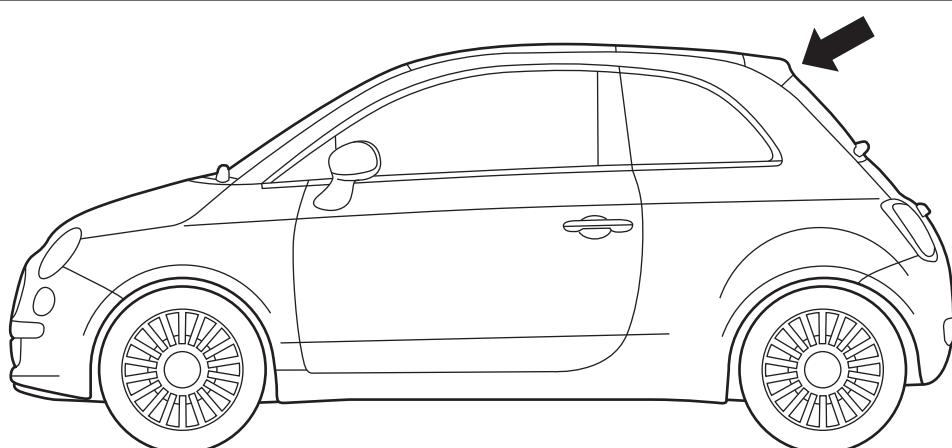
2. Retirer le contour du gabarit et positionnez-le au dessus du hayon arrière et appliquez-y un ruban gommé de faible adhérence pour le maintenir en place. Assurez-vous que les coins gauche et droit de sa partie arrière sont à égalité avec les coins du hayon. À l'aide du poinçon, marquez l'emplacement des trous. Retirez le gabarit.
