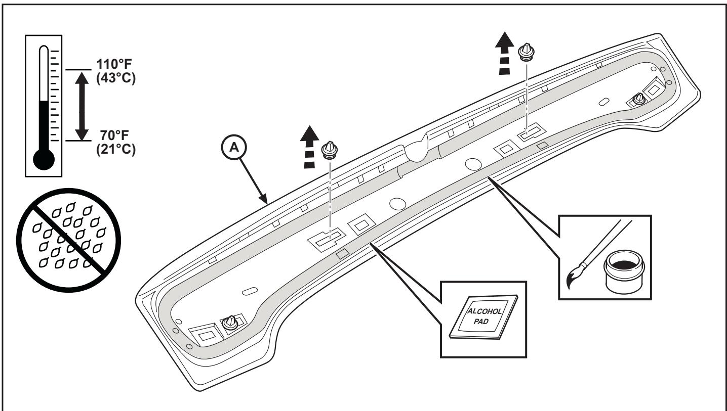
6. Appliquez un filet continu d'adhésif à l'uréthane MS-CD927 à l'intérieur de la rainure intérieure de l'aileron. Commencez à l'endroit indiqué et appliquez l'adhésif en sens horaire sur le pourtour en gardant un flux constant d'adhésif à tout moment. Évitez de laisser des bulles d'air dans l'adhésif. Pour terminer, appliquez quatre « boutons » d'adhésif aux quatre coins comme montré.
