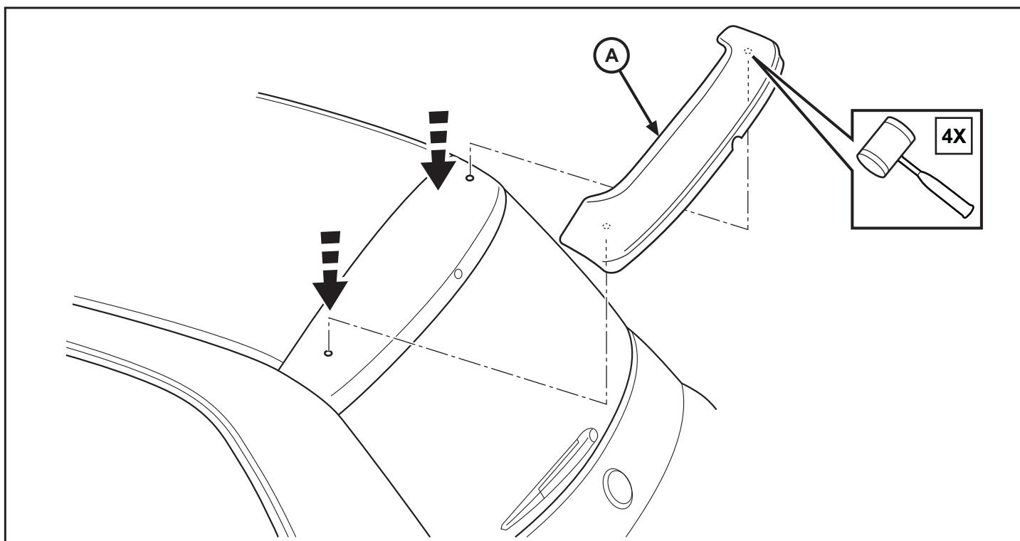
8. Ouvrez le hayon et fixez l'aileron en enroulant du ruban de faible adhésion autour les bords gauche et droit comme montré. Refermez le hayon et appliquez du ruban le long du bord d'attaque de l'aileron comme montré.
