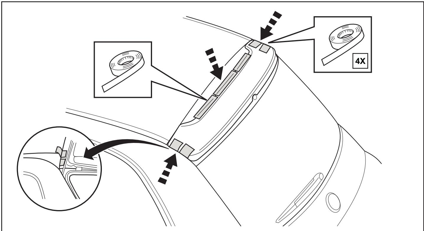
9. À l'aide d'un rouleau ou de vos mains appliquez une pression de 7 kg (15 lb) d'un côté à l'autre de l'aileron pour que le filet d'adhésif siège bien sur le toit.
