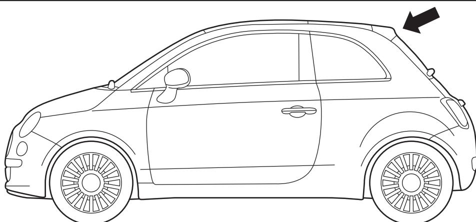
2. Recorte la plantilla, colóquela sobre la parte superior de la compuerta trasera y adhiérala con cinta de adhesión baja. Compruebe que las esquinas delantera izquierda y derecha estén a nivel con las esquinas de la compuerta. Marque con un punzón las ubicaciones de los orificios. Retire la plantilla.
