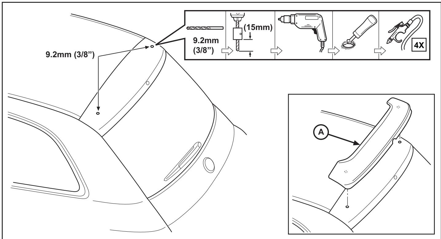
4. Use alcohol para limpiar perfectamente la superficie de la parte superior de la compuerta.
