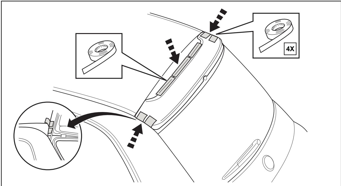
9. Utilice un rodillo o la mano para ejercer una presión uniforme con 15 lb. de fuerza hacia uno y otro lado del deflector, a fin de asentar correctamente el adhesivo.
