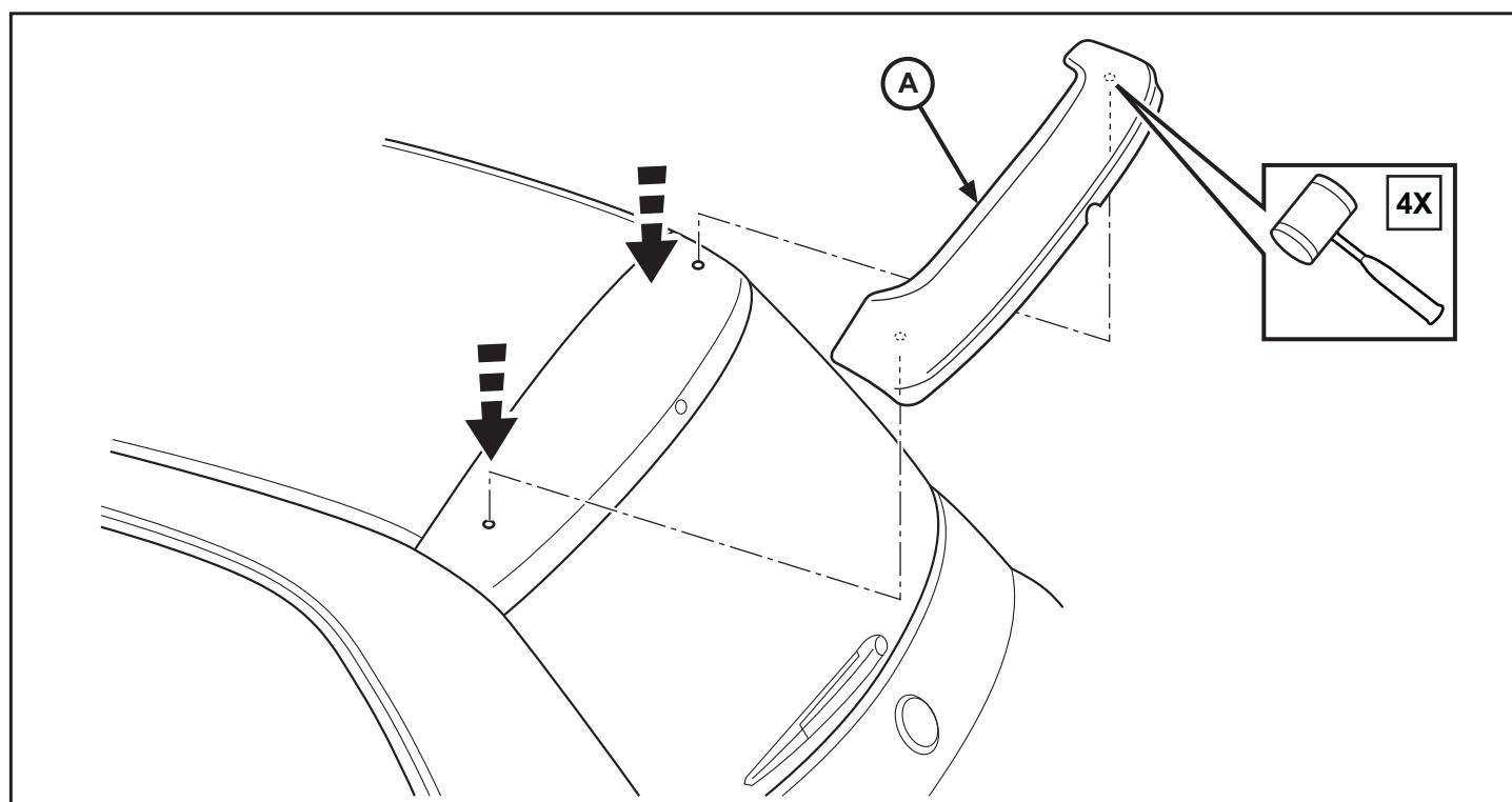
8. Abra la compuerta trasera y sujeté el deflector de aire envolviendo cinta de adhesión baja alrededor de los bordes izquierdo y derecho, según se ilustra. Cierre la compuerta trasera y aplique cinta en el borde frontal del deflector de aire, según se ilustra.
