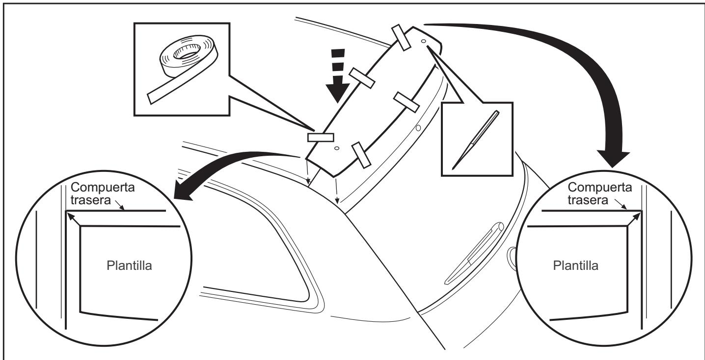
3. Taladre dos (2) orificios de 9.2mm (3/8"), uno en cada posición que se marcó. Utilice un tope de taladrado a 15mm a fin de no taladrar a demasiada profundidad. Utilice una herramienta para quitar rebabas a fin de limpiar cada orificio. Sostenga en posición el deflector de aire en el vehículo, a fin de verificar el ajuste de los orificios con respecto a los dos broches de montaje antes de aplicar el adhesivo.
