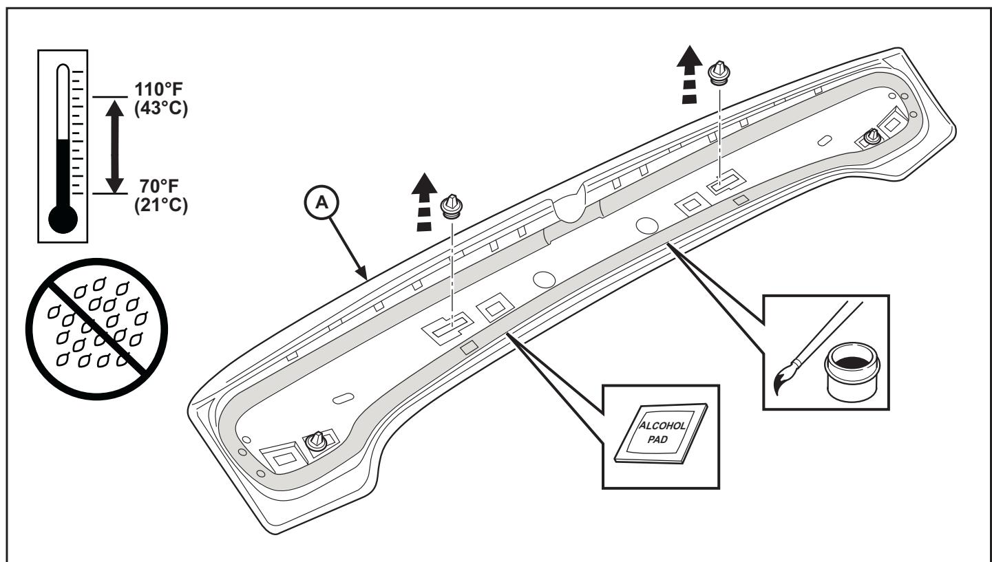
6. Aplique un cordón continuo de adhesivo de uretano MS-CD927 a la superficie ranurada interior del deflector de aire. Comience en el punto que se ilustra y aplique el adhesivo alrededor, hacia la derecha, conservando una cantidad uniforme de adhesivo en todo momento. Evite que se formen burbujas. Para terminar, aplique cuatro "botones" de adhesivo en las esquinas, según se ilustra.
