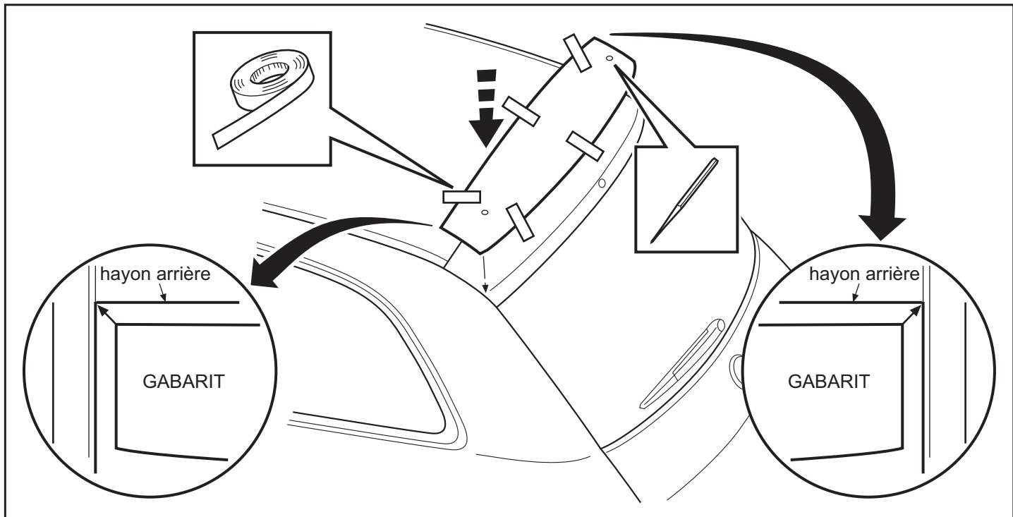
3. Percez un trou de 9,2 mm (3/8 po) à chacune des deux marques de perçage. Pour prévenir de pénétrer trop profondément, réglez la butée de perçage à 15 mm. Ébavurez les trous à l'aide d'un outilponceur à cet effet. Vérifiez la bonne correspondance du perçage en montant l'aileron en position sur les attaches de retenue avant l'application de l'adhésif.
