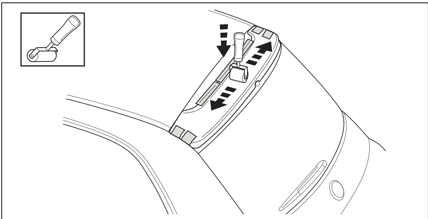
10. **Permita que se fije el adhesivo durante 6 horas.** Retire todas las secciones de cinta y limpie cualquier residuo que haya quedado en el vehículo.
